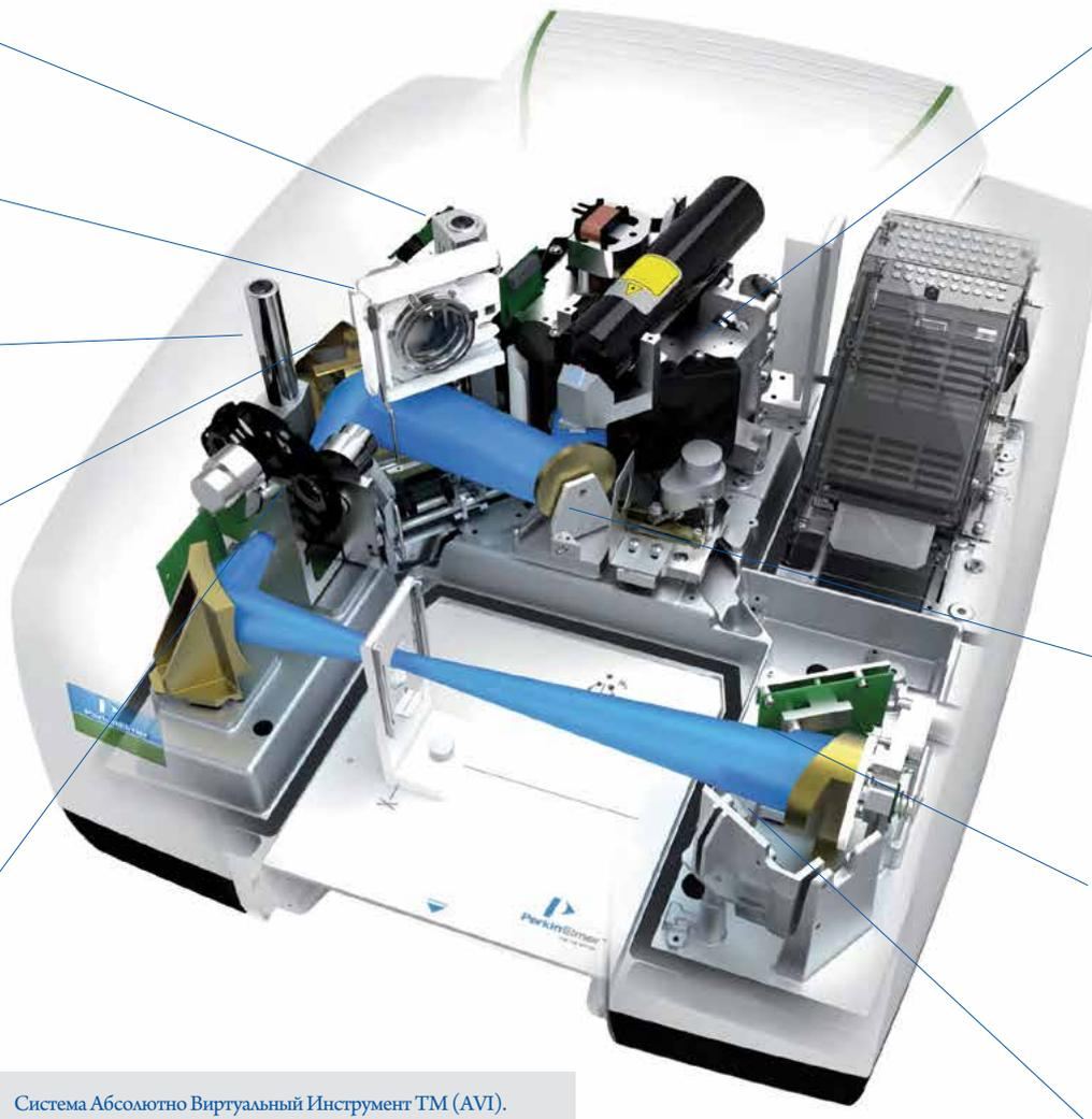
**Запатентованный интерферометр Dynascan™.** Очень стабильная конструкция не требует динамической юстировки для компенсации ошибок возникающих в системах с линейным перемещением зеркал. Проверенный на практике механизм интерферометра включает в себя простой некритический подшипник для непревзойденной долговечности и надежности
