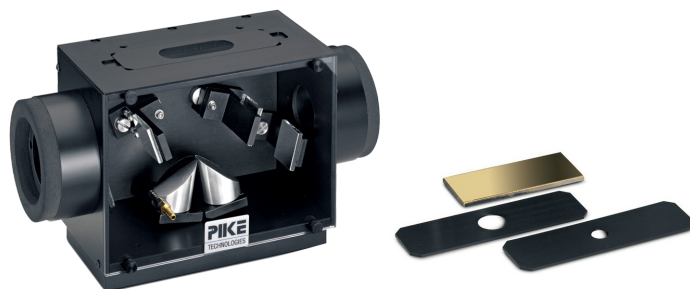
Рис. 2: Приставка относительного зеркального отражения с набором диафрагм и контрольным зеркалом
