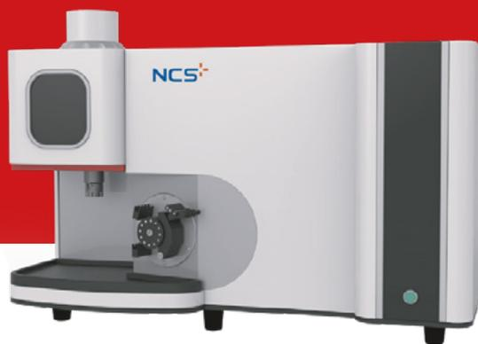
Plasma 3500 создан для количественного элементного анализа методом ИСП-ОЭС. Анализ воды, пищи и кормов, почв и отложений, руд, металлов и сплавов, стекол и керамики, пластиков и нефтепродуктов, удобрений и любых веществ для определения содержания основных и примесных элементов - метрологические характеристики Plasma 3500 достаточны для большинства практических задач.
