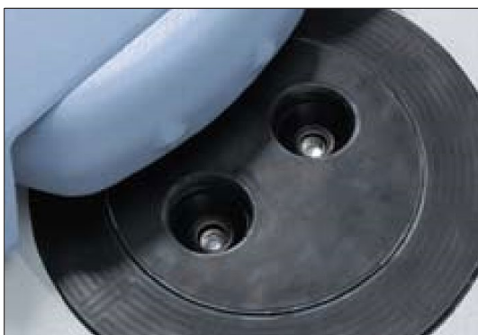
Рис 1. Конструкция с двумя печами позволяет измерять тепловой поток напрямую
