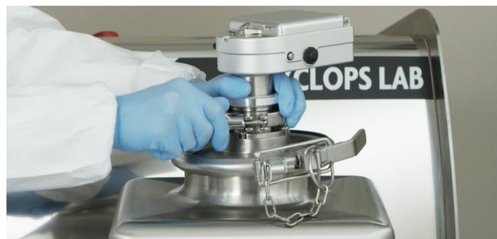
Рис. 8: Подключение БИК-спектрометра MicroNIR PAT-W к вращающемуся блендеру и траектория перемешивания
