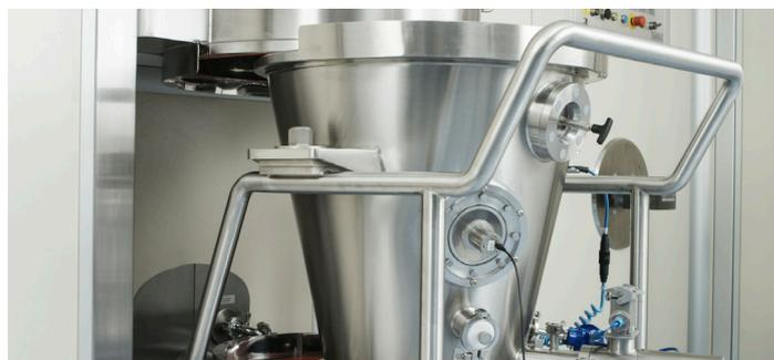
Рис. 6: Подключение БИК-спектрометра MicroNIR PAT-U к аппарату для гранулирования
