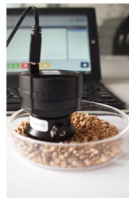
время интегрирования одного спектра составляло 9.6 мс, число накоплений – 1000. Таким образом, регистрация спектра одного образца занимала примерно 9.6 секунды.
