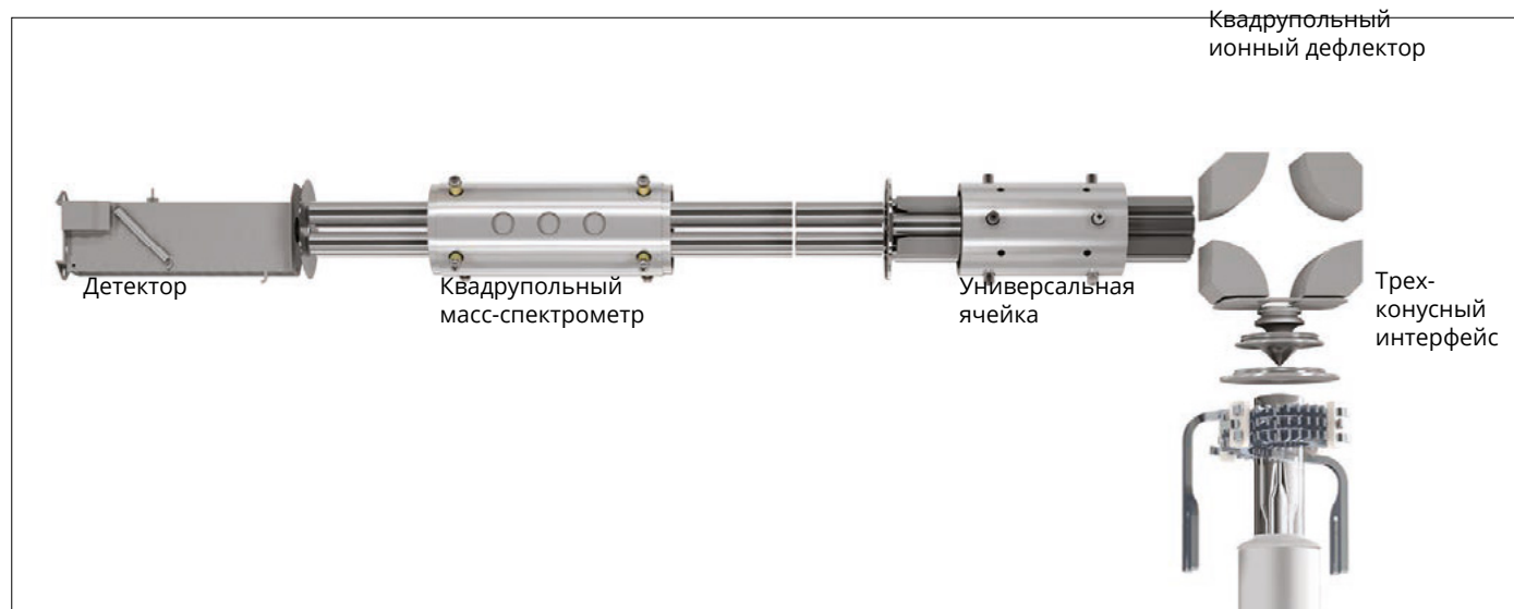
Рисунок 5. Упрощенная схема ИСП-МС системы с универсальной ячейкой УСТ.
