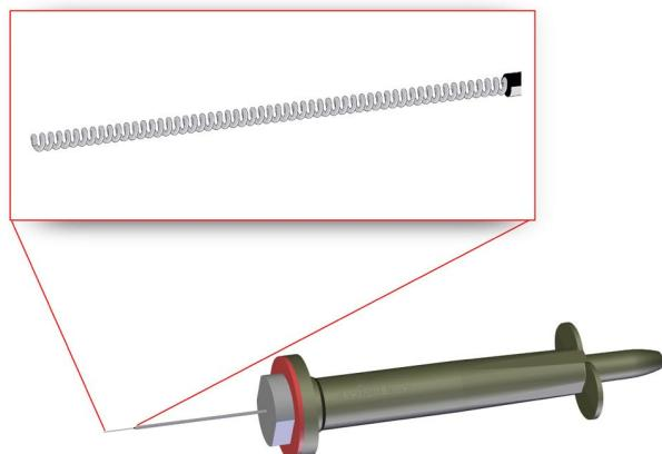
Образец наносился на спиральную нить двумя способами:
