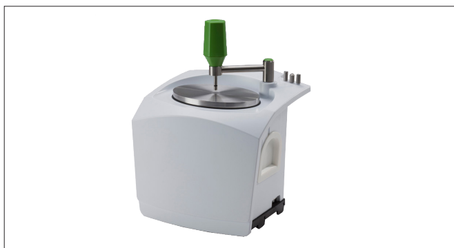
Рисунок 13: Универсальная приставка НПВО для ИК-Фурье спектрометров.
