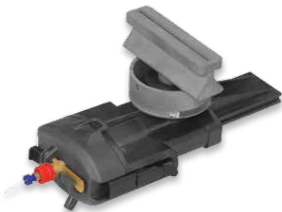
Поскольку не требуется подключение к газовым линиям, блок горелок PinAAcle может быть легко снят без инструментов для простой очистки и легкого переключения между способами анализа.
