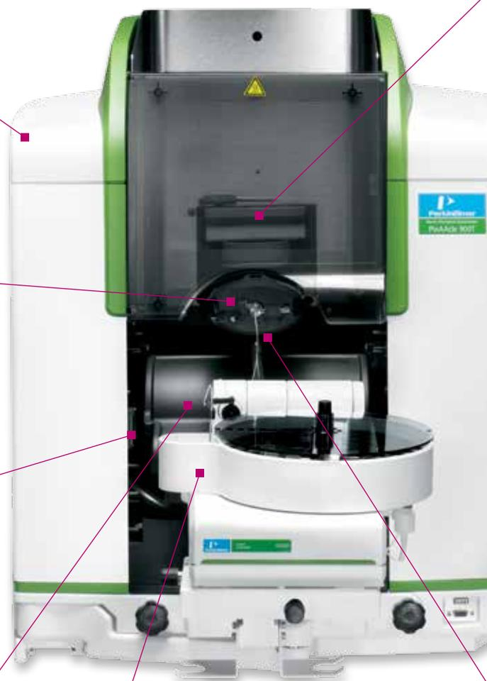
**Уникальная пламенно/печная конструкция:** требует только одного подключения к вентиляционной системе для всех способов атомизации, упрощая установку и сводя к минимуму затраты.
