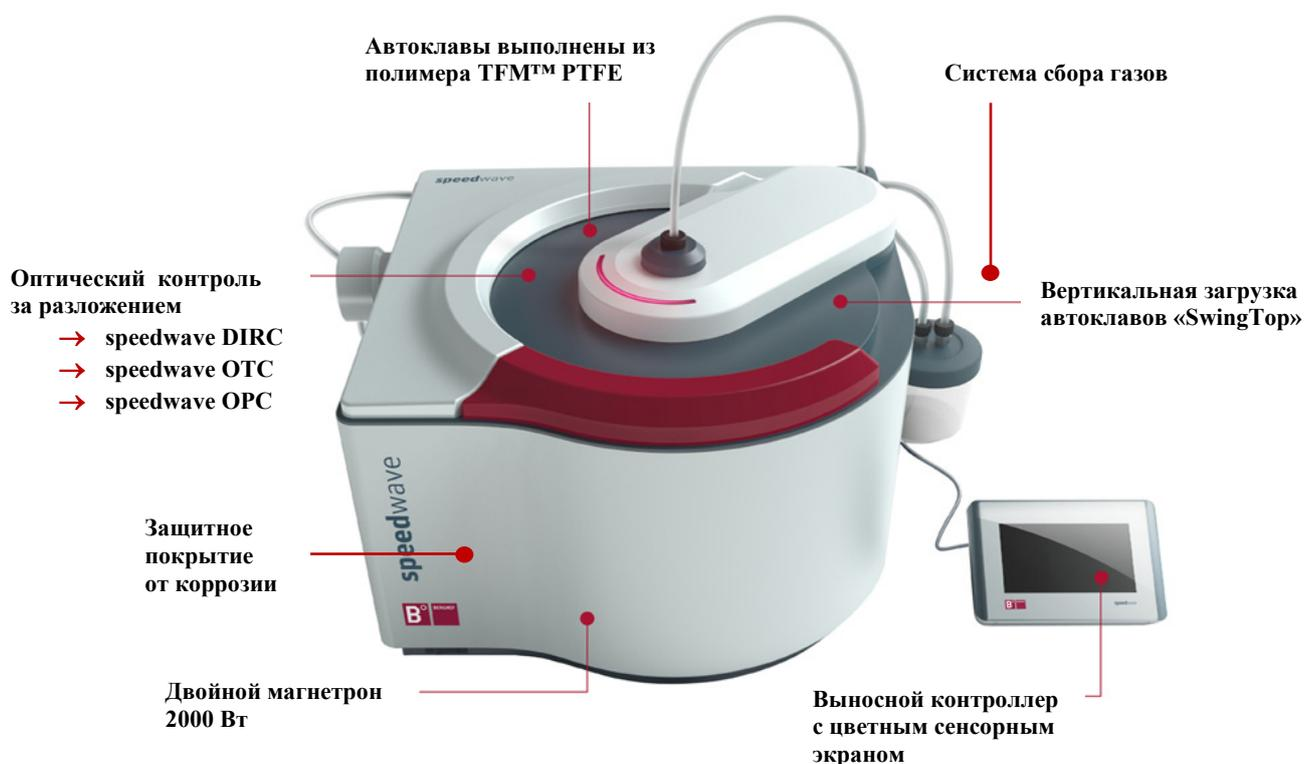
Патентованные оптические процедуры измерения температуры и давления в индивидуальных автоклавах позволяют проводить мониторинг процесса растворения в реальном времени без использования контактных сенсоров.
